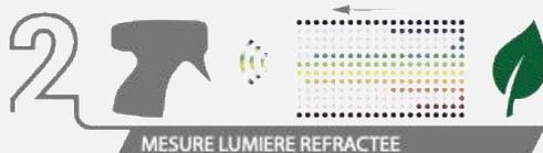
**Recepción de la luz refractada:** cuando la luz interactúa con los tejidos vegetales, algunas longitudes de onda se absorben, mientras que otras se reflejan. El sensor óptico del Nutriscope™ captura con precisión la intensidad de la luz reflejada a través de diferentes longitudes de onda, lo que permite un análisis espectral detallado.
