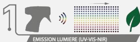
**Emisión de luz sobre la planta:** El dispositivo emite luz desde un conjunto de LED a longitudes de onda ultravioleta (UV), visibles (VIS) y cercanas al infrarrojo (NIR) específicas. Estas longitudes de onda se seleccionan cuidadosamente para centrarse en las propiedades bioquímicas clave de la planta, como el contenido de clorofila, los niveles de nutrientes y los marcadores de estrés.
