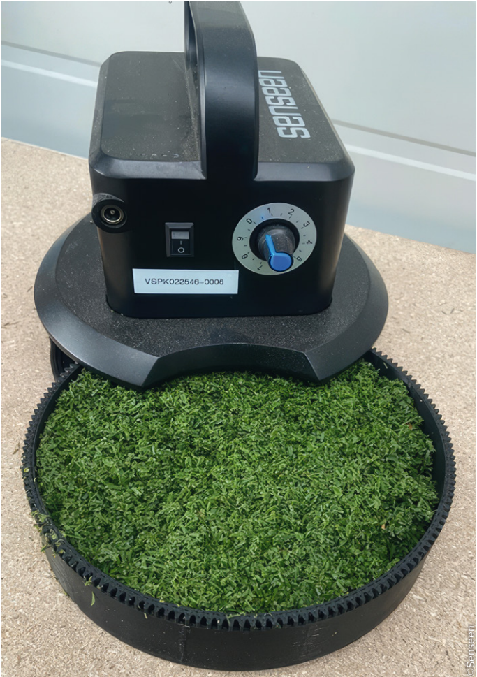
Grâce à la spectrométrie et l'intelligence artificielle, le Nutriscope de Senseen mesure la teneur des minéraux, des oligo-éléments, le pH, le potentiel redox... Des éléments déterminants pour évaluer l'état de stress du gazon et optimiser la fertilisation.
